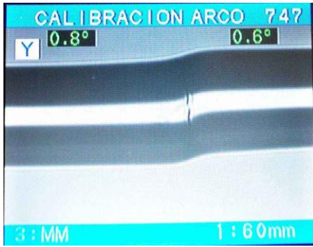
Fig. 5 Calibración por arco
